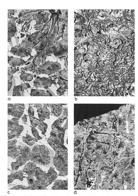
Bild 4: Gefüge stark aufgekohlter Eisenteilchen aus der mittleren Höhenlage des Reduktionsgutes von Rennofenversuchen am Magdalensberg. Massstab: 100:1 a) grosser Versuchsofen, b-d) kleiner Versuchsofen
