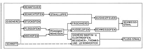
Abbildung 1: Schema der Stahlerzeugung (mit Berücksichtigung älterer Verfahren).
