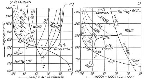
Bild 3: Gleichgewichte für die Reduktion von Wüstit zum Eisen und dessen Aufkohlung durch CO –  $CO_2$  – Gasgemische (berechnet). (Nach E. Schürmann) a) für  $pCO + pCO_2 = 1$  bar b) für  $pCO + pCO_2 = 0.4$  bar
