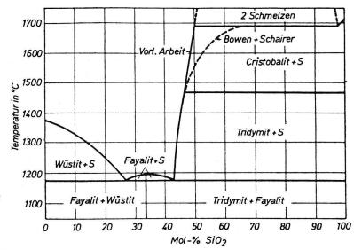
Bild 2: Das Zustandsschaubild (FeO) - (SiO<sub>2</sub>). (Nach N.L. Bowen und J.F. Schairer sowie H. Schenck und G. Wiesner)
