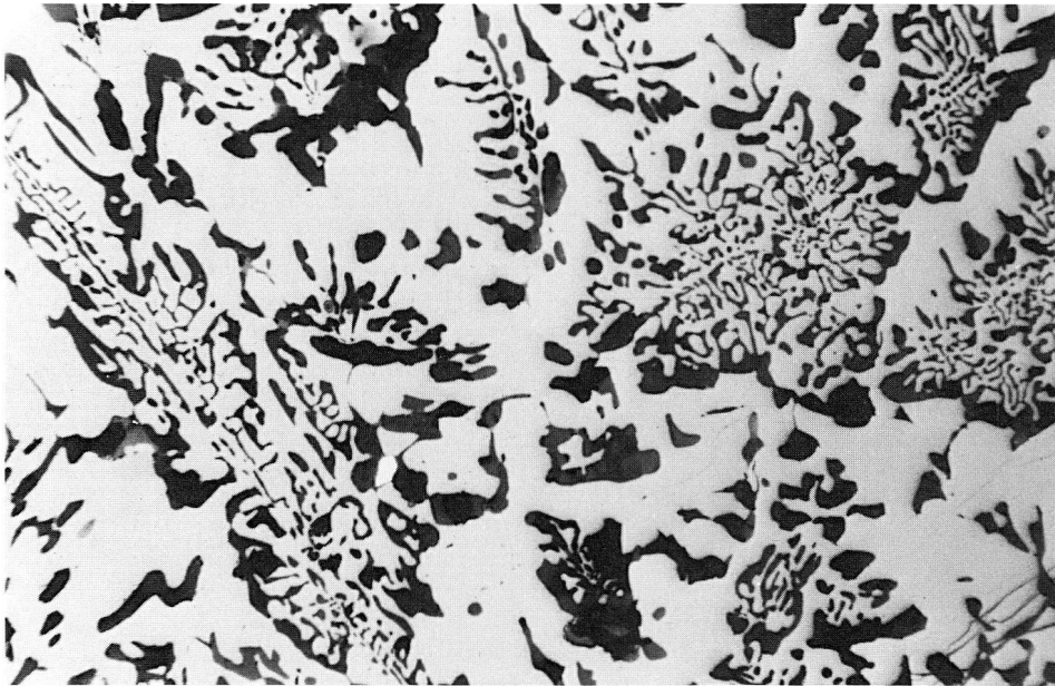
Die chemische und mineralogische Untersuchung von Verhüttungsschlacken ist das wichtigste Mittel für die Rekonstruktion früher Hüttenprozesse. Chemische Zusammensetzung und Phasenbestand geben hier Aufschluss über die prozesstechnischen Parameter während des Schmelzprozesses. Hier eine eisenzeitliche Schlacke, die bei der Verhüttung reiner hämatitischer Erze anfiel. Sie besteht aus Wüstit (hell) mit eutektischen Verwachsungen von fayalitischem Olivin + Wüstit. Probe Jd-17/1, Tell edh-Dhahab/Jordanien. Vergr.: 200x, Oelimmersion, Auflicht.
