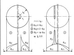
Bild 1: Spannungen in umlaufenden Wellen.
