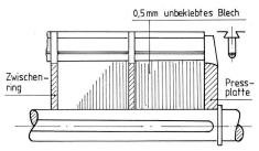
Bild 2: Prinzip der geblechten Turbowelle.
