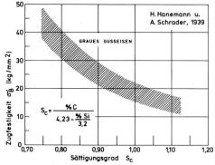
Abbildung 4: Einfluss des Sättigungsgrades auf die Zugfestigkeit grauen Gusseisens. Nach H. Hanemann und A. Schrader.<sup>11</sup>
