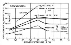
Abbildung 2: Einfluss des Kohlenstoffgehaltes unlegierter Stähle (Kohlenstoffstähle) auf ihre Zugfestigkeit bzw. Streckgrenze nach unterschiedlicher Wärmebehandlung. Nach H. Jüptner-Jonstorff.<sup>5</sup>
