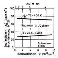
Abbildung 3: Einfluss der Korngrösse auf Zugfestigkeit und Bruchdehnung eines Schienenstahles. Nach H. Jüptner-Jonstorff.<sup>6</sup>
