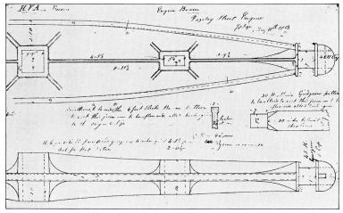
Bild 5: Gusseiserner Balancier (Watt 1803)
