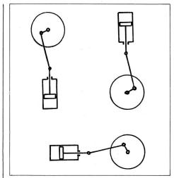
Bild 7: Neue Bauformen stationärer Dampfmaschinen (ab etwa 1870)
