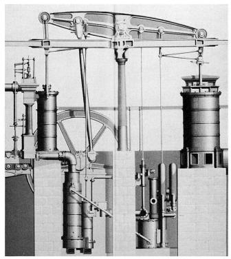
Bild 6: Dampfmaschine für Hochofengebläse mit Gusseisen-Balancier (um 1850)
