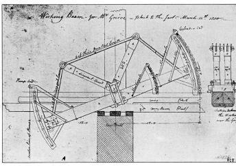
Bild 3: Fachwerk-Balancier (Watt 1800)
