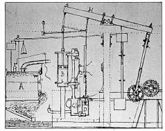
Bild 1: Doppeltwirkende Niederdruck-Dampfmaschine mit Balken-Balancier (Watt 1769)
