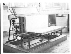
Frühe Dampfstossform (aufgeklappt) zum Ausschäumen einer Styroporplatte
