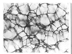
Geschlossenzellige Struktur von geschäumtem Polystyrol (Styropor) in mikroskopischer Vergrös-
