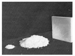
Vergleich der «Grössenordnungen» von ungeschäumtem (links) zum vorgeschäumten Granulat und ausgeschäumtem Formkörper (rechts)
