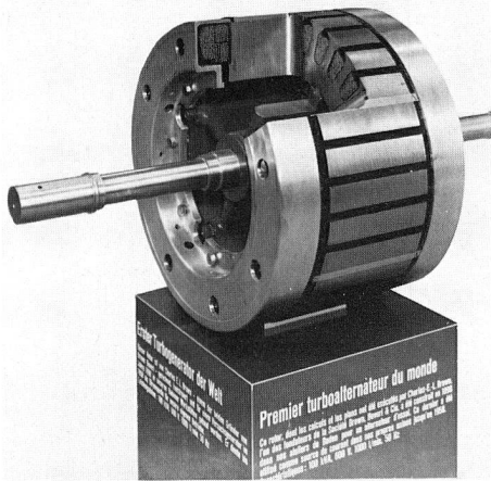
Bild 4: Turbogenerator-Rotor, Patent C. E. L. Brown 1901.
