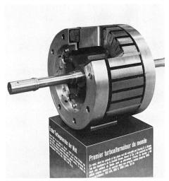
Bild 4: Turbogenerator-Rotor, Patent C. E. L. Brown 1901.
