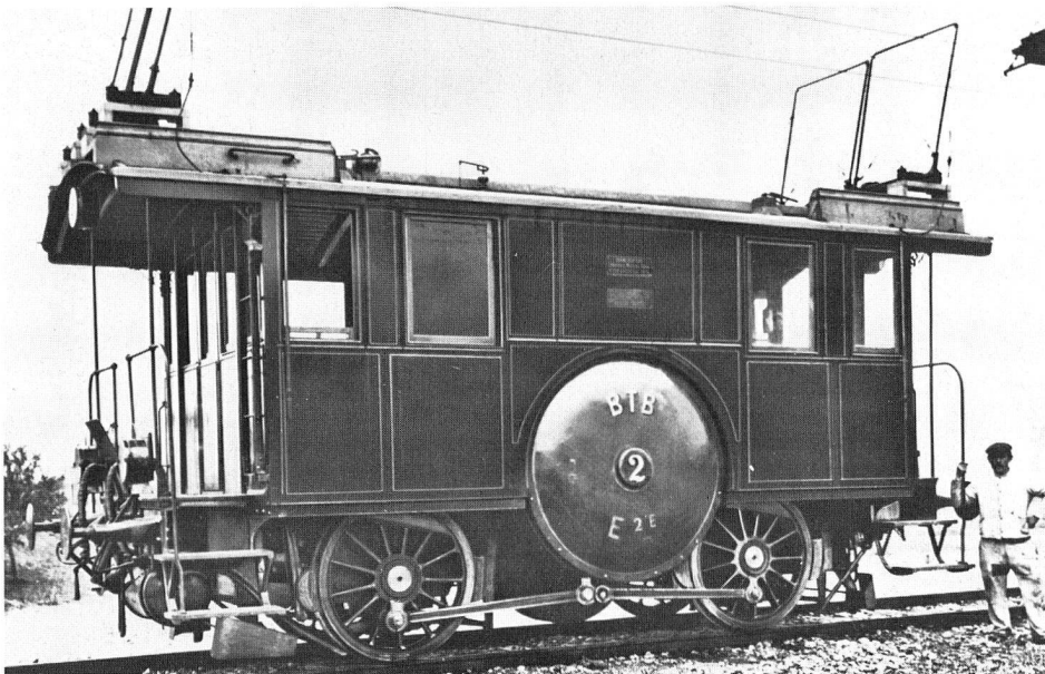
Bild 6: Drehstromlokomotive der Burgdorf–Thun-Bahn, erste elektrische Vollbahnlokomotive Europas 1899. (Copyright für alle Bilder: Brown Boveri.)
