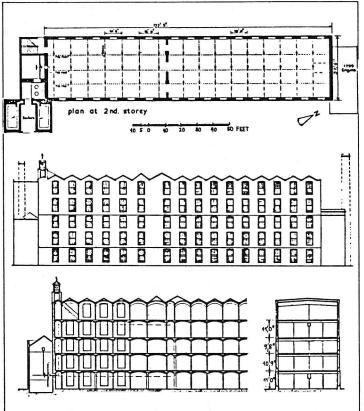
Flax Mill Shrewsbury, 1796–97, erster Massivbau mit reinem Eisenskelettausbau.
