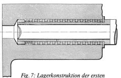
Fig. 7: Lagerkonstruktion der ersten Parsonsturbine
