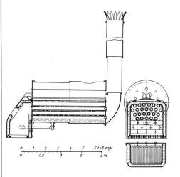
Fig. 2: Schnitt durch den Kessel der «Rocket»
