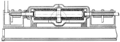
Fig. 6: Erste Parsonsturbine, Leistung 7,5 kW
