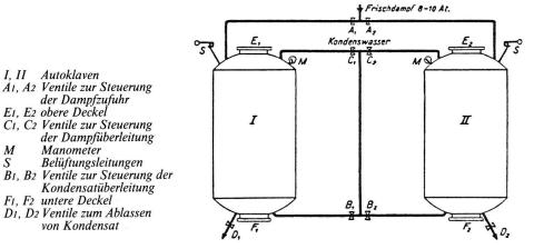
Versuchsanlage zur Kohlentrocknung, Schema<sup>10</sup>.
