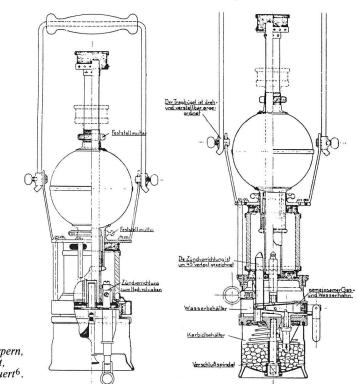
Versuchslampen mit kugelförmigen Klangkörpern, links mit Benzin befeuert, rechts mit Azetylen befeuert<sup>6</sup>.
