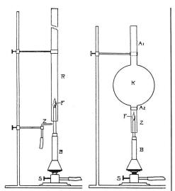
Versuchsanordnungen mit röhren- und kugelförmigen Klangkörpern<sup>5</sup>.
