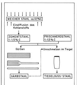
Abb. 1: Herstellung von Zement-, Gärb- und Tiegelgußstahl (schematisch).
