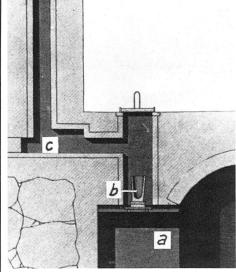
Abb. 2: Tiegelstahlofen älterer Bauart<sup>7</sup> (1808). a Feuerung
