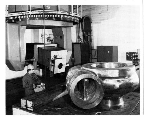
Durchstrahlungsprüfung eines Pumpengehäuses mit dem Linearbeschleuniger
