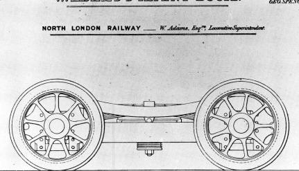
Radsatz eines Bahnwagens von 1860 (Drehgestell). Aus. W. Adam's Patent Bogie. s.l. et s.a.
