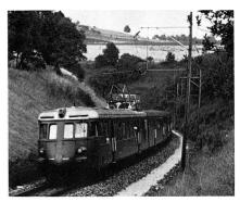
Moderner Triebwagenzug von 1955 (Schweiz). Leichtstahlwagen befuhren zwar schon 1939 einige Strecken, wurden aber erst nach dem Kriege richtig eingesetzt.
