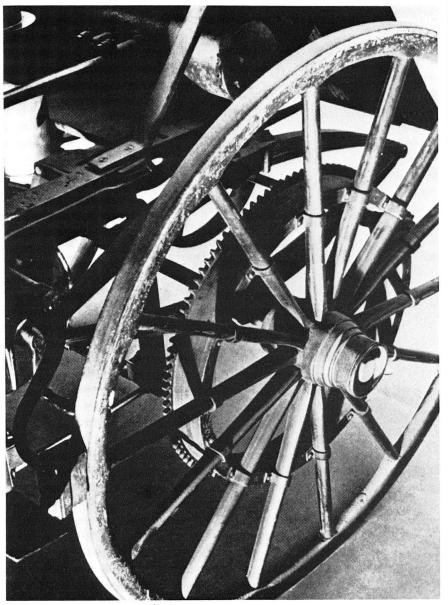
Detailansicht des erstens Wagens von DAIMLER (1887). Am Hinterrad wurde eine einfache Zahnradübertragung angebracht. Aus: ICKX, J. Ainsi naquit l'automobile. Lausanne, s.a.
