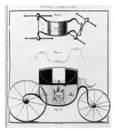
Diese Kutsche ist an Stahlfedern aufgehängt und nicht an Gurten – eine Erfindung von 1769, die in England zuerst ausprobiert wurde.
