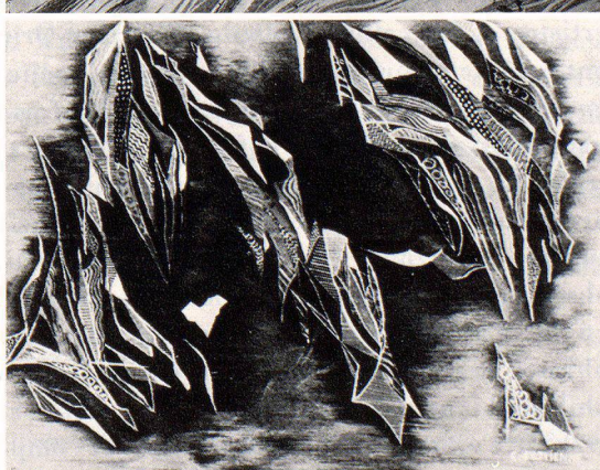
Fig. 6. Oxyde de fer—Croissance en aiguilles par oxydation de fer pur dans un mélange H_2/H_2O à 800^\circ C (J. Manenc - IRSID)
