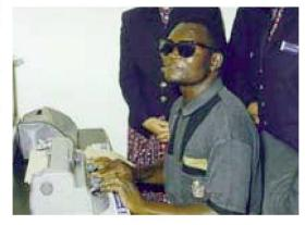
"Perkins Brailler" OPunktschrift-Schreibmaschine: Stumpfe Nadeln drücken von unten auf das Papier und erzeugen die Braillepunkte.
