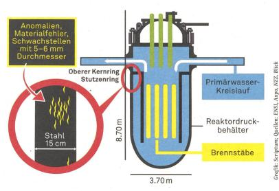
Im Reaktordruckbehälter (RDB) von Beznau I wurden rund 1000 Einschlüsse, sprich Materialfehler und Schwachstellen, festgestellt. Käme es im Reaktordruckbehälter zum Sprödbruch, versagt die Kühlung des Kernbrennstoffs. Es kommt zur Kernschmelze und führt unweigerlich zum Super-GAU.
