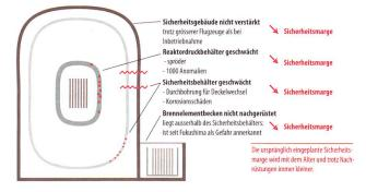
Die Grafik zeigt eine Auswahl der grössten Sicherheitsdefizite des AKW Beznau I, die zur Minderung der Sicherheitsmarge beitragen. Gewisse Defizite entstehen durch Materialermüdung, andere durch nicht aktuelle Sicherheitszustände, insbesondere bei der Gebäudehüllendicke. Weitere Defizite sind im Zuge von Nachrüstungen entstanden, etwa die Schwächung des Sicherheitsbehälters durch den Deckelaustausch.
