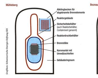
Reaktorgehäude Sicherheitsbehälter (auch Reaktorbehälter Containment genannt) aktordruckbehälter Brennstäbe Gebäuderingraum Abklingbecken für abgebrannte Brennelemente
