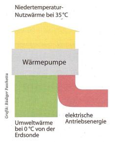
Energiefluss bei einer Erdsonden-Wärmepumpe. Der grössere Teil (hier ca. 70%) der erzeugten Heizwärme wird der Erdsonde entnommen, ca. 30% werden in Form elektrischer Energie benötigt.
