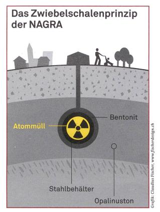
Die Nagra sieht mehrere Schutzbarrieren vor. Die «strahlende Zwiebel» soll 400 bis 900 Meter tief im Wirtgestein Opalinuston liegen.
