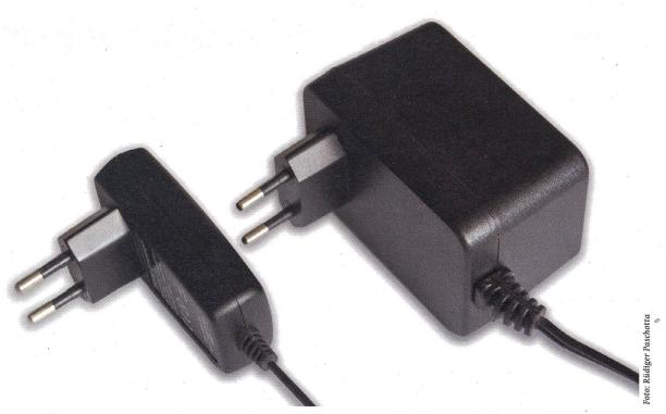
Grössere Steckernetzteile (rechts) verursachen häufig weit mehr Standby-Verbrauch als moderne Schaltnetzteile (links).
