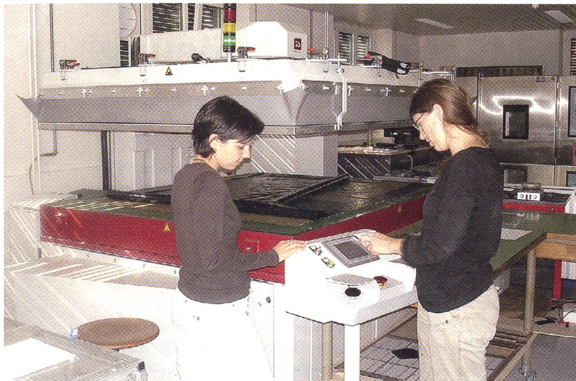
Bild links: Marylene Barnéoud-Raeis und Vanessa Terrazoni an einer Presse, welche die lichtsensiblen Folien samt Elektroden in Glas oder Kunststoffe einschweisst. Bild rechts: Peter Bühlmann tüftelt an verschiedenen Zusammensetzungen der lichtführenden Schichten und Oberflächen.
