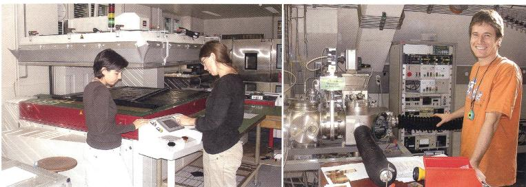
Bild links: Marylene Barnéoud-Raeis und Vanessa Terrazoni an einer Presse, welche die lichtsensiblen Folien samt Elektroden in Glas oder Kunststoffe einschweisst. Bild rechts: Peter Bühlmann tüftelt an verschiedenen Zusammensetzungen der lichtführenden Schichten und Oberflächen.
