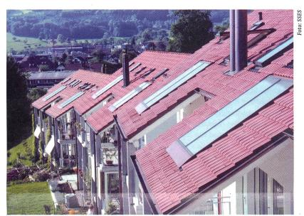
Energieeffizienz pur: Warmes Wasser von Sonnenkollektoren statt vom Elektroboiler oder von der Öl- und Gasheizung.
