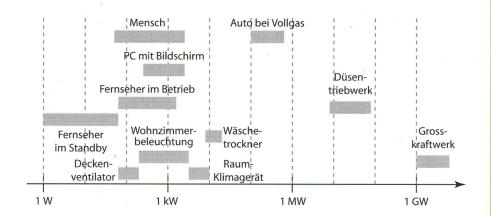
Primärenergieumsatz diverser Verbraucher: Der Wirkungsgrad der Stromerzeugung wurde als 30% angenommen. Man beachte den weiten Bereich z.B. bei den Fernsehern mit elektrischen Leistungen zwischen ca. 20 W (kleines LCD-Gerät) und 500 W (grosser Plasmabildschirm). Beim Menschen gelten die oberen Werte des Bereichs für kurzfristige starke Anstrengung.
