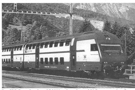
Der SBB-Doppelstockzug IC 2000 verbraucht rund 30 Prozent weniger Strom als eine Standard IC-Zug. Dennoch ist eine weitere Senkung um 20 Prozent technisch möglich.
