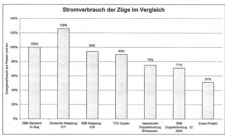
Laut Enper-Berechnungen ist es technisch möglich, einen Doppelstockzug zu bauen, der nur noch die Hälfte des Stromes eines Standard IC-Zuges der SBB verbraucht.
