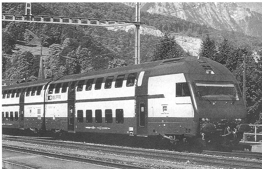
Der SBB-Doppelstockzug IC 2000 verbraucht rund 30 Prozent weniger Strom als eine Standard IC-Zug. Dennoch ist eine weitere Senkung um 20 Prozent technisch möglich.
