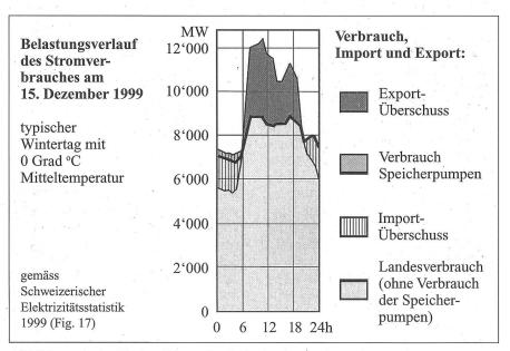
Abbildung 1: An diesem Dezember-Mittwoch wurde in der Nacht Strom aus europäischen Kohle- und Atomkraftwerken importiert und über Mittag wurde der eigene Wasserkraftstrom exportiert.
