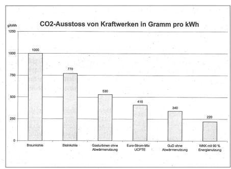
Abbildung 2: Strom aus WKK-Anlagen produziert die Hälfte weniger CO<sub>2</sub> als der Euro-Strommix, welcher im Winter in Schweizer Elektroheizungen verbrannt wird.
