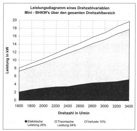
Die technische Neuheit des Mini-BHKWs liegt darin, dass die Drehzahl in Umdrehungen pro Minute (U/min) variabel ist. Bei höherem Wärmebedarf wird die Drehzahl erhöht und damit auch die Leistung.
