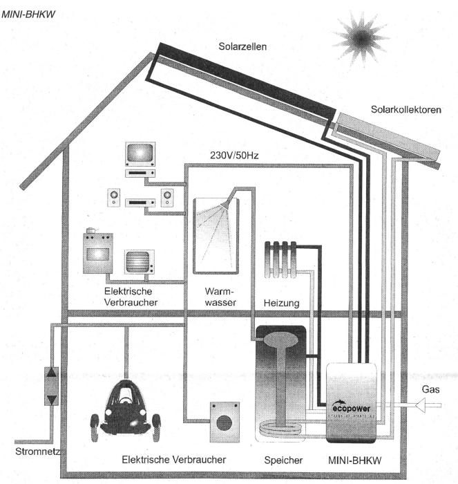
Gasbetriebenes Mini-BHKW in Kombination mit solarer Heizungsunterstützung, Photovoltaikanlage, Leichtelektromobil und Rücklieferung von Strom ins Netz.
