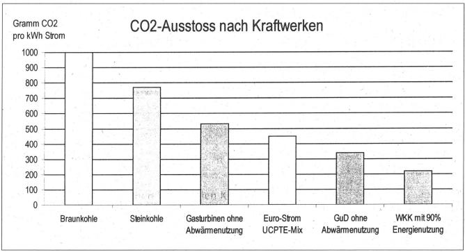
Bild 3: CO2-Emission verschiedener fossiler Kraftwerke
