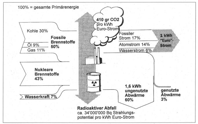
Bild 1: Verluste und Emissionen pro Kilowattstunde Eurostrom (UCPTE: EU-Länder und Schweiz, ohne Grossbritannien und Skandinavien): Neben 1,6 kWh ungenutzter Abwärme wird 410 gr CO<sub>2</sub> und ein radioaktives Strahlungspotential von 34'000'000 Becquerel erzeugt. Quelle: RAVEL, Bundesamt für Konjunkturfragen – aktualisiert mit neuen statistischen Daten des Statistischen Jahrbuchs der UCPTE
