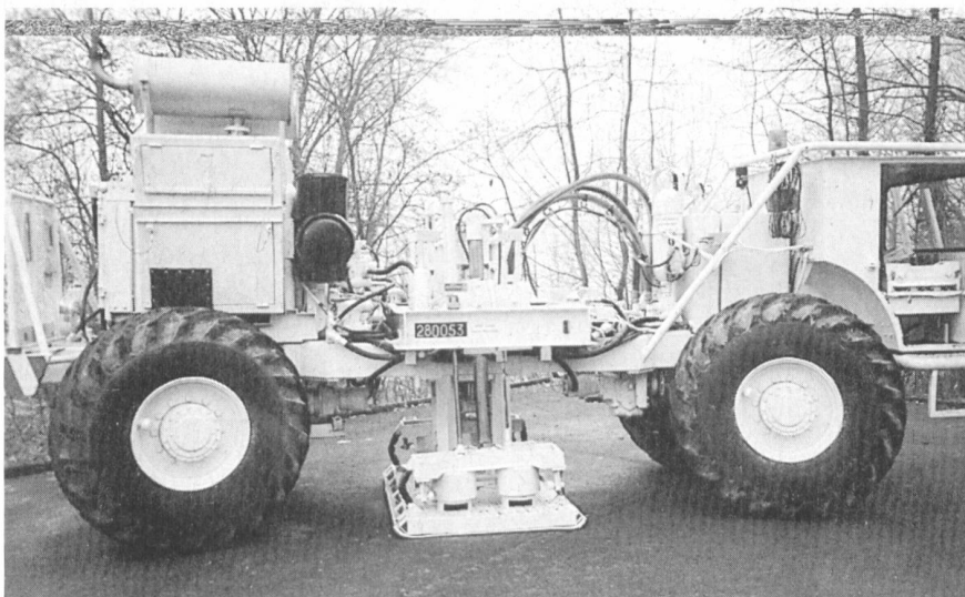
Das Fahrzeug für seismische Messungen im Weinland.
