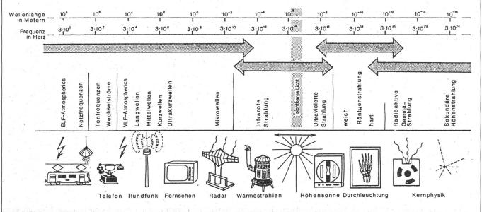
Die Netzfrequenz von 50 Hz und die Frequenz des Bahnstromes von 16 2/3 Hz gehören zu den tiefsten Frequenzen im elektromagnetischen Spektrum. Quelle: Elektro K.Fischer
