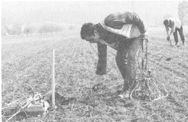
Nagra-Leute vermessen geologische Schichten mit Reflexionsseismik: Beweis für Endlagerung radioaktiver Abfälle schuldig
