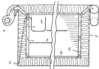
**Energiespar-Kühlschrank** © J. Nipkow, Schnitt parallel zur Tür. 1 Ventilator, 2 Kältemittelleitung zum Kompressor, 3 Verdampfer, 4 Blechgehäuse, 5 Luftverteil-Hohlräume, 6 Stegdoppelplatten, 7 Lagertable (Gitter)
