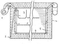
Energiesparkühlschrank © J. Nipkow, Schnitt parallel zur Tür. 1 Ventilator, 2 Kältemittelleitung zum Kompressor, 3 Verdampfer, 4 Blechgehäuse, 5 Luftverteil-Hohlräume, 6 Stegdoppelplatten, 7 Lagertablare (Gitter)
