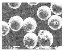
Brennstoffkugeln der feinsten Uranoxidfraktic Bestrahlungsexperiment im KKW Gösgen. Aufnahr EIR-Bericht Nr. 559
