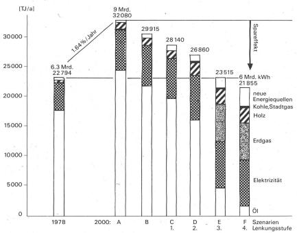
Abbildung 1. Energieszenarien für den Kanton Graubünden. Gesamtbedarf und Zusammensetzung der Energieträger (in Terajoule TJ = 10<sup>13</sup>J). Die offizielle Verschwendungspolitik führt zu einem Bündner Energiekonsum im Jahr 2000 von 32080 TJ oder rund 9 Milliarden kWh. Der Weg einer echten und vernünftigen Politik lässt den Konsum langfristig stabilisieren und bis zum Jahr 2000 leicht senken auf 21855 TJ oder 6 Milliarden kWh (F4).
