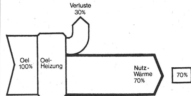
Ersetzt man eine herkömmliche Ölheizung (Skizze links) durch eine Wärme-Kraft-Kopplung-Anlage (rechts), so kann man mit dem erzeugten Strom eine Wärmepumpe betreiben und erreicht so einen Anstieg der Nutzwärme von 70 Prozent auf 130 Prozent.
