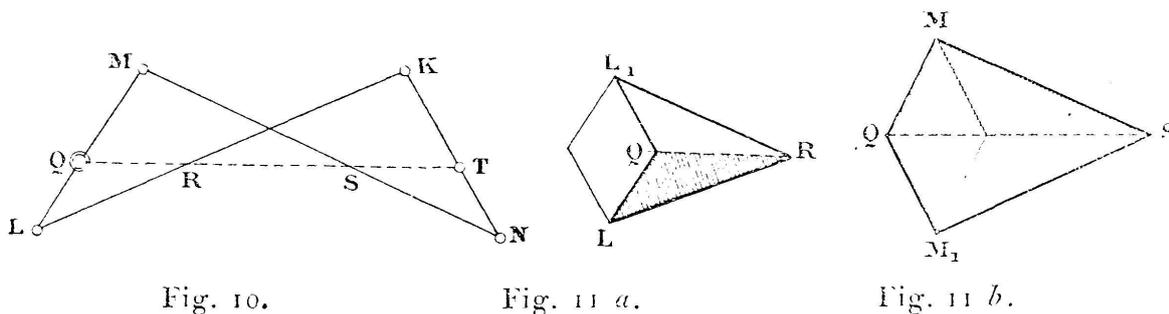
en des points Q, R, S, T. Si l'on construit les symétriques des triangles LQR et MQS par rapport à la droite QT, on a les figures LQRL<sub>1</sub> et MQSM<sub>1</sub> (fig. 11 a et 11 b) qui représentent les parties CAPD et CBPD de l'inverseur Peaucellier.
