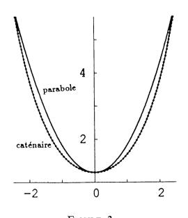
FIGURE 3. Caténaire et parabole.
