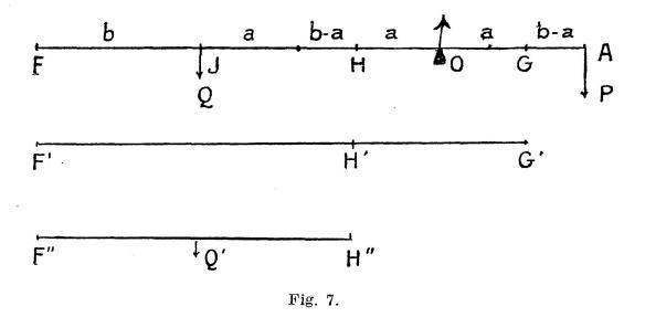
Le poids P équilibrant le cylindre E'G' (fig. 7), retranchons de celui-ci une partie HG = 2. OG et suspendons-la par son milieu J sur le prolongement du levier. L'équilibre subsistera encore, car si Q est le poids de E'H' ou E"H", on a:
