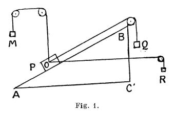
5. — Considérons le corps P (fig. 1) soumis à la force Q, que nous remplacerons par les deux poids M et R. D'après ce qui précède les trois forces M, Q, R sont respectivement proportionnelles et parallèles aux côtés BC, AB, AC du triangle.
