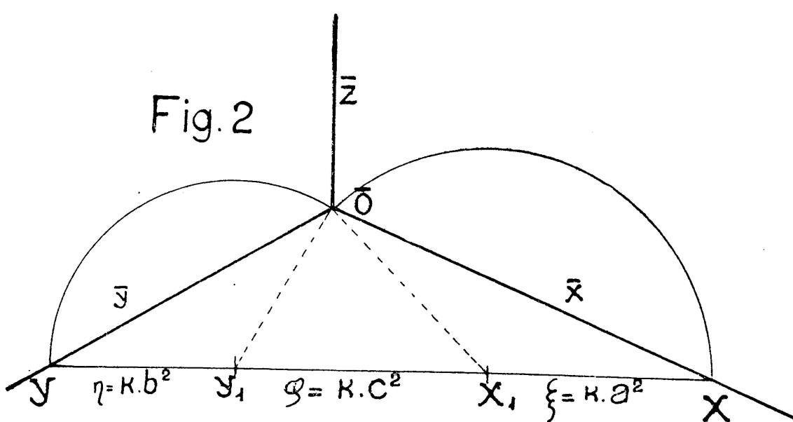
Dans les plans projetants des axes  $x$  et  $y$  se trouvent les triangles rectangles  $OXX^*$  et  $OYY^*$  qui contiennent aux sommets  $X$  et  $Y$  les angles de pente  $\alpha$  et  $\beta$ .
