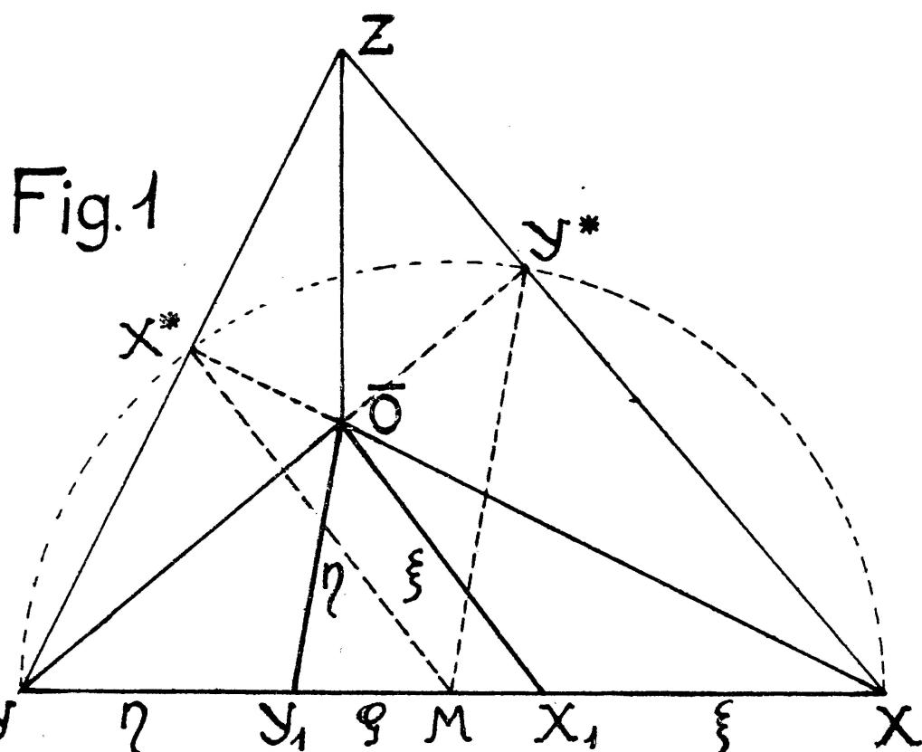
on le sait, ils sont les hauteurs du triangle (aigu) axonométrique XYZ, c'est-à-dire du triangle déterminé par les traces des trois axes sur le plan de dessin.
