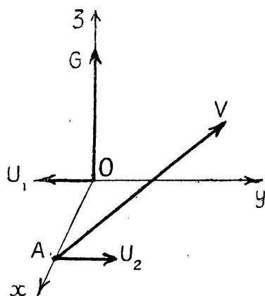
22. *Produit d'un couple par un vecteur.* Soit  $\vec{G}$  l'axe du couple, porté par  $Oz$ ; je prends pour  $Ox$  la perpendiculaire commune à  $\vec{G}$  et au vecteur donné  $\vec{V}$ ; je représente le couple par deux vecteurs  $\vec{U}_1$  et  $\vec{U}_2$  parallèles à  $Oy$ , dans le plan  $xOy$  ( $\vec{U}_1$  issu de  $O$ ,  $\vec{U}_2$  issu de  $A$
