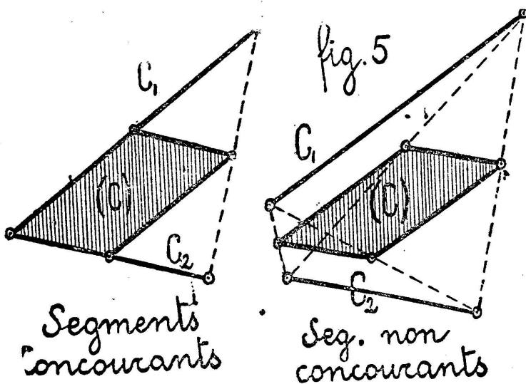
Si l'on utilise l'espace à trois dimensions, la variété moyenne cherchée sera l'intersection, par le plan ( $z = 1$ ), d'un tétraèdre, dont l'arête  $C_1$  sera dans le plan primitif ( $z = 0$ ) et dont l'arête  $C_2$  sera dans le plan ( $z = 2$ ); on sait que cette section est un parallélogramme, dont les côtés ont pour valeurs respectives  $\left(\frac{C_1}{2}\right)$  et  $\left(\frac{C_2}{2}\right)$ .
