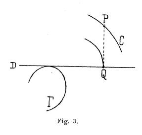
Ce problème peut avoir des applications intéressantes si la droite D est un levier qui s'appuie sur la came  $\Gamma$ . Il peut permettre des transformations de mouvements alternatifs en mouvements continus, ou réciproquement. Si le levier D est manœuvré à la main, on peut se donner la courbe C de façon que la main de l'opérateur
