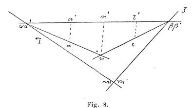
formée par les 2 projections se compose de 5 droites; si les droites du plan sont parallèles, il y en a 4; si l'on donne les traces, 3 droites suffisent (P, Q', xy). Il n'y a également que 3 droites sur la figure si l'on donne le plan par une droite et un point, ou par 3 points (lignes de rappel).
