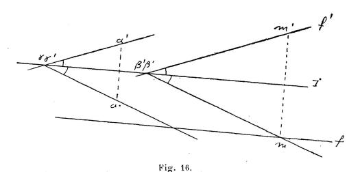
projections DD', le plan de bout D' coupe le plan donné suivant la droite  $\beta'a'$ ,  $\beta a$ , rencontrant D en m, d'où m' sur D'. 3 droites de construction.
