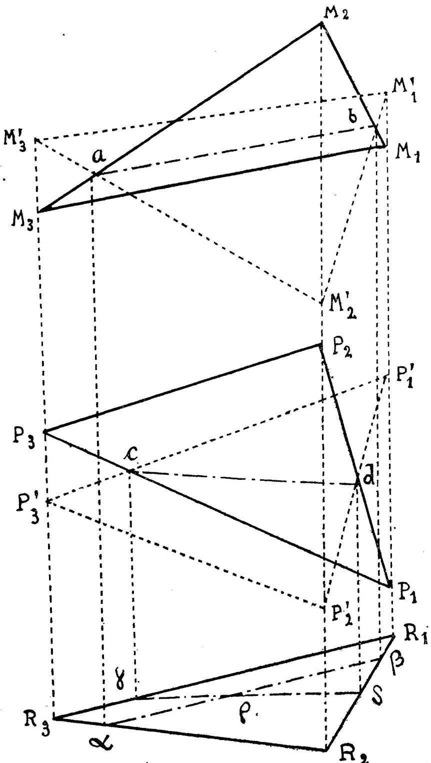
Considérons la parallèle aux projectantes menées par  $\varrho$ , elle coupe les surfaces  $(M)$  et  $(M')$  en deux points  $\mu$  et  $\mu'$ . Les plans tangents à  $(M)$  et  $(M')$  en ces points ont pour intersection une droite  $\Delta\mu$ .
