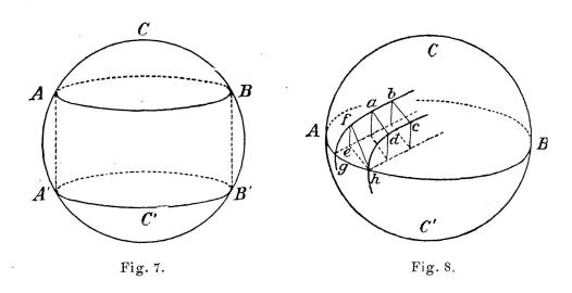
(13) Considérons (fig. 8) dans un corps solide, la calotte ACB détachée par une section plane AB et supposons que l'on prolonge toutes les ordonnées de cette calotte, perpendiculaires à la section, d'une quantité égale à leur propre longueur; il en résultera une nouvelle surface AC'B symétrique de ACB par rapport à la section AB. Nous allons démontrer que le corps AC'B possède exactement la même valeur de surface enveloppe et la même valeur de volume que son symétrique ACB.
