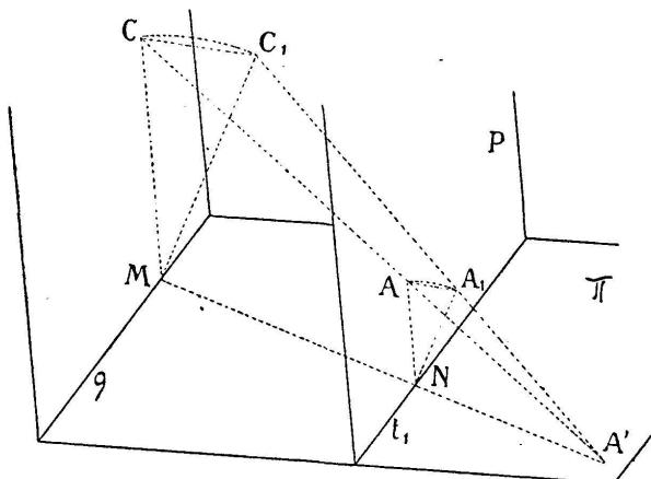
Soit (fig) le point  $A'$  du plan  $\pi$  comme projection centrale du point  $A$  situé dans le plan  $P$ , relativement au centre  $C$ . Faisons tourner  $P$  d'un angle  $\varphi$  autour de  $t_1$  et en même temps et dans le
