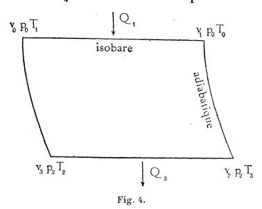
se passant comme dans le cycle II. En particulier toutes les conséquences restent les mêmes. Remarquons seulement que la température la plus élevée T<sub>0</sub> doit être appliquée à l'angle 1, la plus basse T<sub>2</sub> à l'angle 3.
