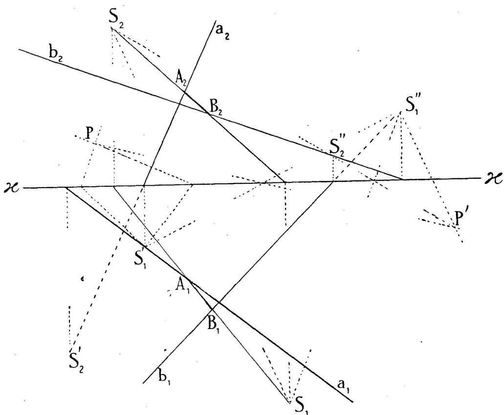
$a \equiv (a_1, a_2)$ ,  $b \equiv (b_1, b_2)$  sont les droites données, on mène par  $P$  les normales à  $a_1, b_1$ ; de leurs points de rencontre avec la ligne de terre on mène les normales à  $a_2, b_2$ ; le point où elles se coupent est le point cherché.
