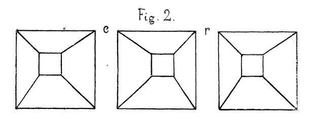
On voit qu'elle représente la surface intérieure ou extérieure d'une trémie selon qu'on met dans le stéréoscope les deux figures de gauche ou celles de droite.
