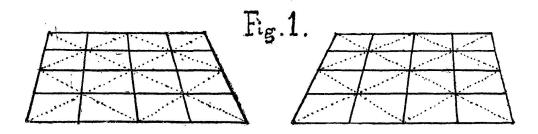
Un autre principe du dessin stéréoscopique, c'est que dans la représentation d'une figure en relief les faces du côté d'un œil doivent être élargies; le contraire a lieu quand la figure doit se présenter en creux.
